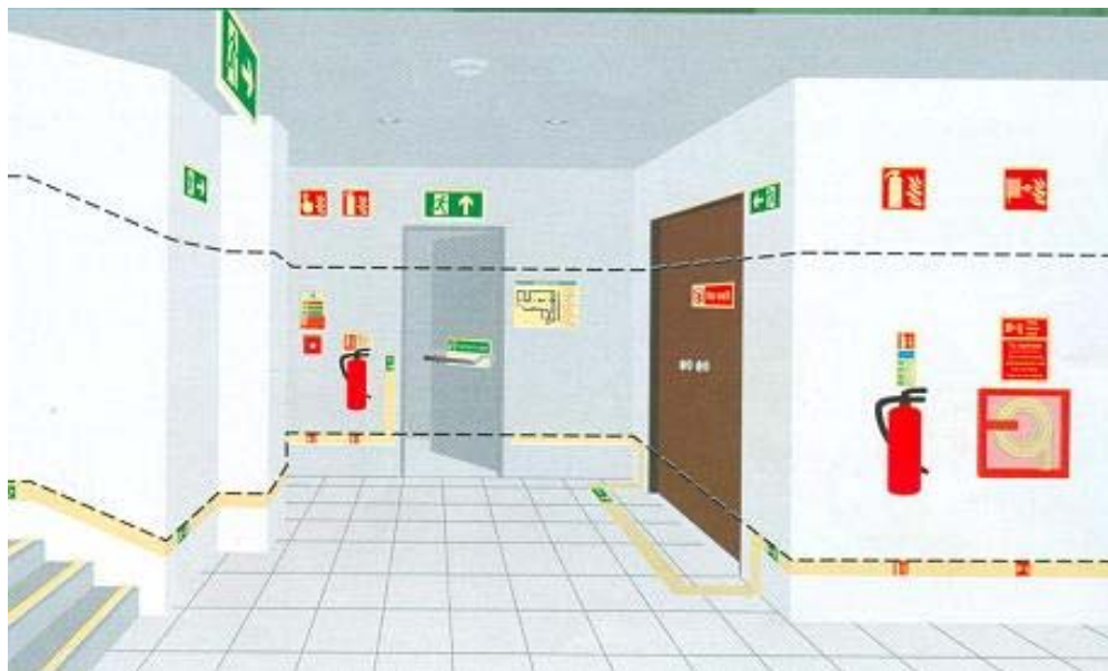
شکل ۴: مکانهای مختلف احتمالی نصب تابلو
